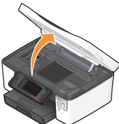
**Nota:** O cabeçote de impressão move para a posição de instalação do cartucho.
